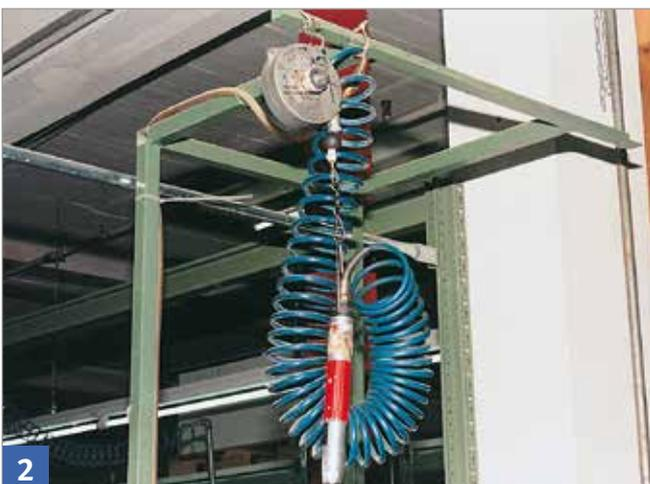
An stationären Montagearbeitsplätzen sollten zur Arbeitserleichterung Balancer, z. B. Federzüge, eingesetzt werden. Die Rückholkräfte dürfen die Arbeit nicht erschweren, d. h. sie dürfen einem Andruck nicht wesentlich entgegenwirken.
