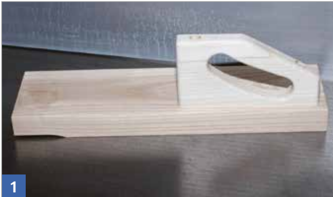
1 Beim Abrichten kurzer Werkstücke ein Schiebeh Holz (Bild 1)
