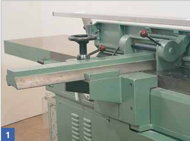
1 Anschlagführung ist gleichzeitig Messerwellenverdeckung.
