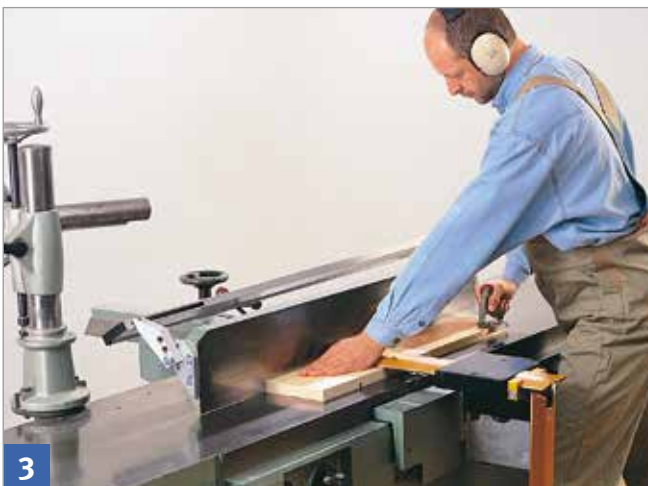
3 Schutzbrücke auf Werkstückdicke einstellen. Werkstück mit Schiebeh Holz unter der Schutzbrücke durchschieben, so dass auch während der Bearbeitung die gesamte Messerwelle von oben verdeckt ist.
